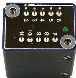
Dévissez les 2 vis du transfo, côté picots, et placez 2 rondelles en nylon sur les trous.
