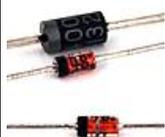
Implantez D5 à D9. Utilisez le gabarit de pliage pour plier les pattes à 0.4 pouce.
