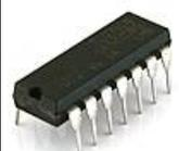
Insérez U3 et soudez. Il sera nécessaire de plier les pattes légèrement vers l'intérieur pour l'insertion. Assurez-vous que vous n'êtes pas chargé en électricité électrostatique avant de manipuler le circuit intégré (en retirant vos chaussures par exemple).
