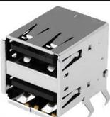
Implantez le connecteur de type USB CN30. Assurez-vous qu'il repose bien à plat sur le CI.
