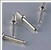
Soudez les 20 picots de test. Insérez du côté composants, partie courte en avant. Il est parfois nécessaire de presser un peu, avec une pince, pour les mettre en place.
