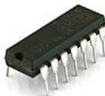
Insérez et soudez U1, U2, U3, U4. Il sera nécessaire de plier les pattes légèrement vers l'intérieur pour l'insertion.
