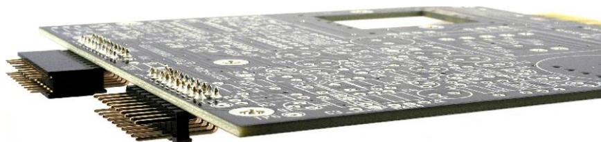
**Attention** : Les connecteurs sont placés du côté soudures du circuit.
