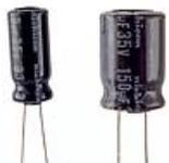
Ajoutez C1, C2. Ces condensateurs sont installés **sous** le circuits, du **côté soudures**.
