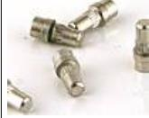
Soudez les 7 douilles de l'AOD. Soudez-les une par une. Insérez la douille, retournez le circuit et appuyez le contre une surface solide mais souple, telle que liège ou mousse dense, puis soudez. Un positionnement correct des douilles est très important pour l'insertion facile de l'AOD.
