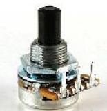
Ajoutez P1, P2, P3 et P4. Insérez les potentiomètres dans les trous du CI depuis la face soudures, en veillant à faire passer les 3 pattes des potentiomètres dans les trous correspondant du CI. Fixer avec rondelle et écrou du côté composants. Bien serrer pour s'assurer de la bonne position du potentiomètre, puis souder.
