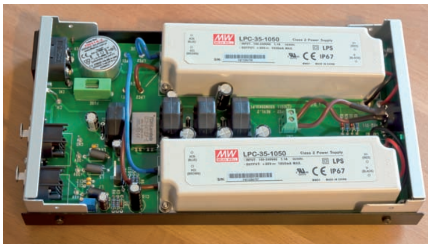
So sieht die fertige bestückte und ins Gehäuse eingebaute Netzteil-Platine aus
